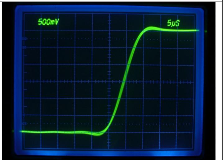
Temps de montée : 8 µSec (Rate: 192kHz)
